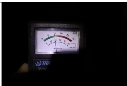
91.att. Koksnes mitruma piesātinājums pie ķieģeļu mūra (15% RH)
