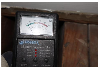
101.att. Koksnes mitruma saturs balsta vietā (7% RH)
