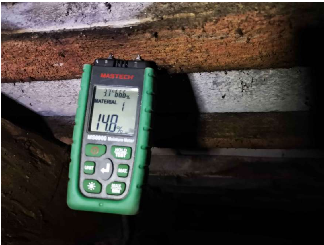
41.fotoattēls Nesošo jumta elementu mitruma mērījumi.
