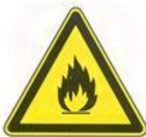
4.1. degoša viela vai ugunsbīstama telpa
