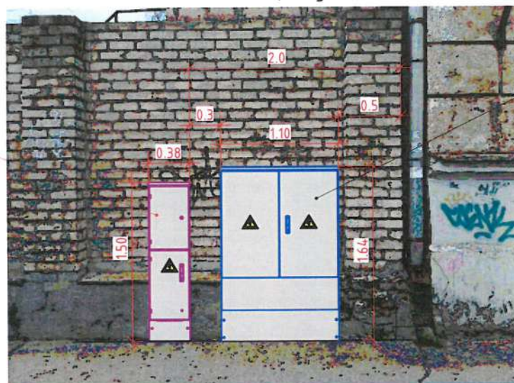
Projektējamās sadalnes uzstādīšanas princips. Vizualizācija Cēsu iela, Rīga
